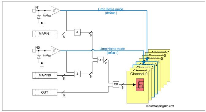
Figure 9 Input Mapping
